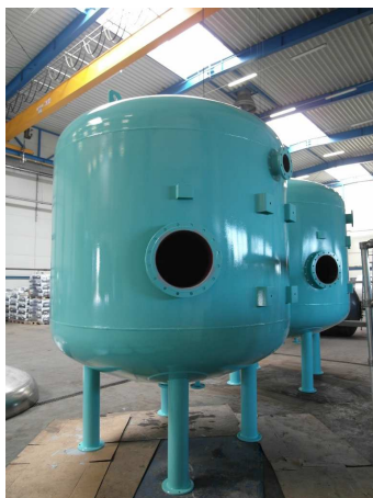
Filtry FERROTEX DN 3000, ciśnienie robocze 6 Bar:
