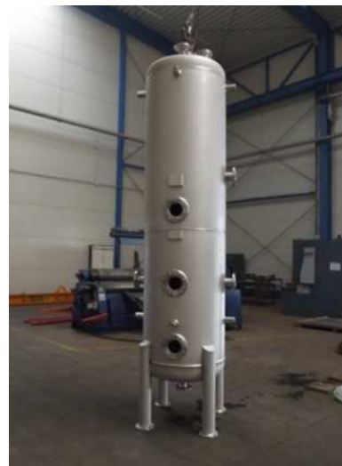
Wymiennik jonitowy DN 800 CE, ciśnienie pracy 20 Bar, wykonany ze stali kwasoodpornej:
