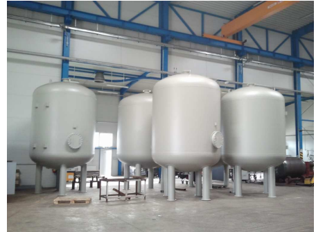
Filtr FERROTEX DN 2400, ciśnienie robocze 6 Bar, wykonany ze stali nierdzewnej:
