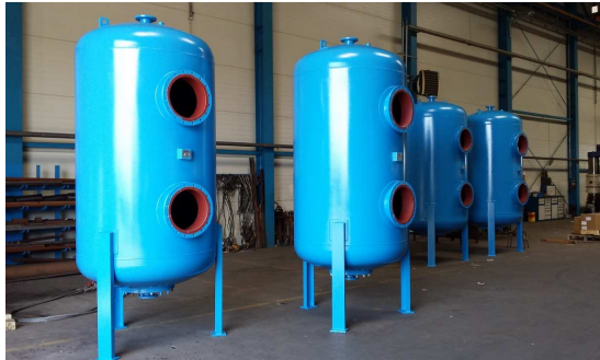
Filtry FERROTEX DN 2400, ciśnienie robocze 6 Bar:
